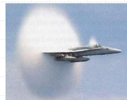
Nagli pad tlaka zraka uzrokuje kondenzaciju molekula vode u zraku, što omogućuje da se uoči udarni val.
